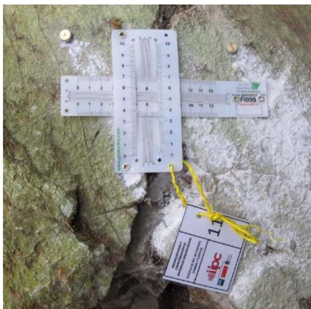
Ejemplo sistemas de monitorización en el punto de control nº 11. Se observa el fisurómetro mecánico que permite evaluar desplazamientos en dos direcciones y los marcadores dorados del fisurómetro digital de registro manual
