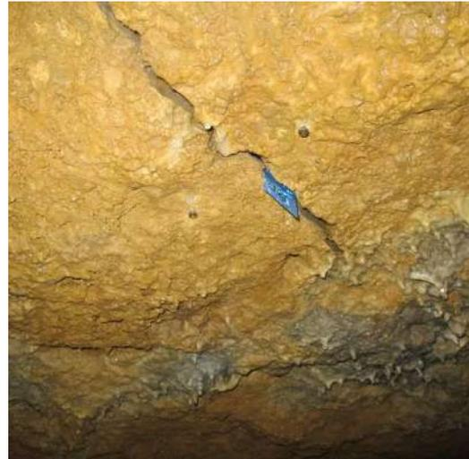
A la izquierda, Instalación correspondiente al fisurómetro digital en continuo. Se observa en el techo de la cueva el sensor de movimiento y al fondo la caja que contiene la unidad de registro. A la derecha, ejemplo de instalación de marcadores para control de apertura de discontinuidades mediante fisurómetro digital manual.
